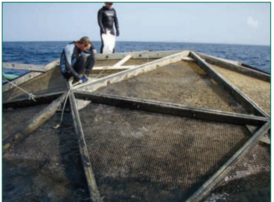
Buzos listos para cosechar de la jaula sumergible Aquapod, subida a la superficie
